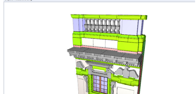
5D-Modell Berliner Stadtschloss: technische und wirtschaftliche Aspekte fließen gleichermaßen von Anfang an mit ein.
